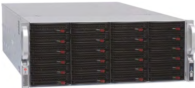
ES-3036 als Hardened Linux Immutable Repository mit 36 Slots (12 davon auf der Rückseite)
